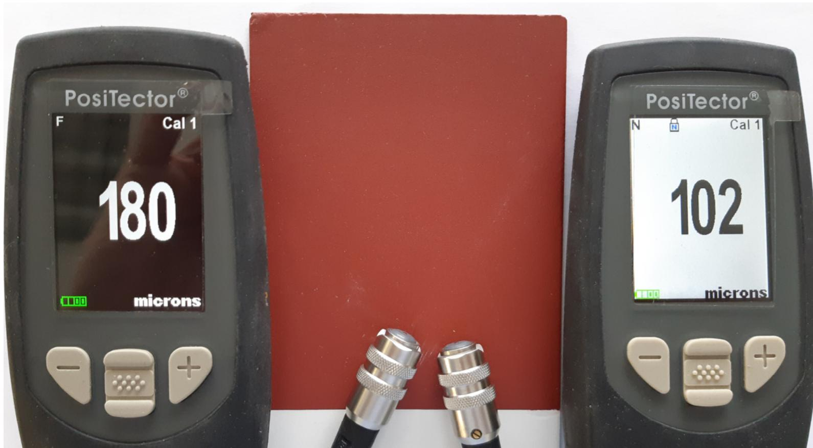
Messung der Beschichtungsdicke ist mit oder ohne
