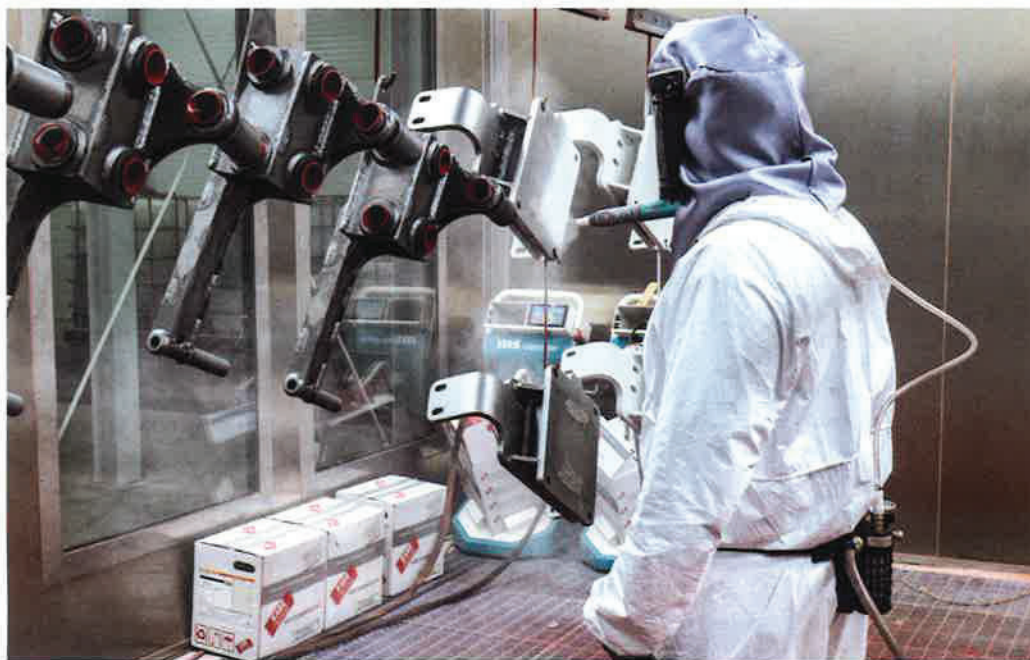
Primer sowie Deck-Pulverlack werden manuell in einer begehbaren Kabine appliziert.
