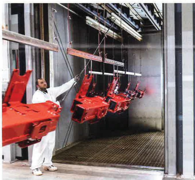
In zwei Kammeröfen werden Primer und der Pulverlack bei 190 bis 200 °C für maximal 30 min eingebrannt.
