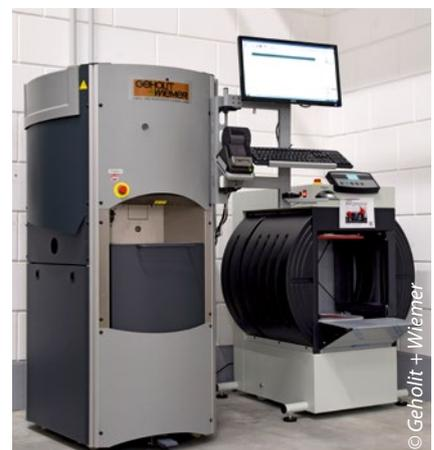
Vollautomatische Farbmischanlage für eine verbesserte Flexibilität im Lackierprozess
