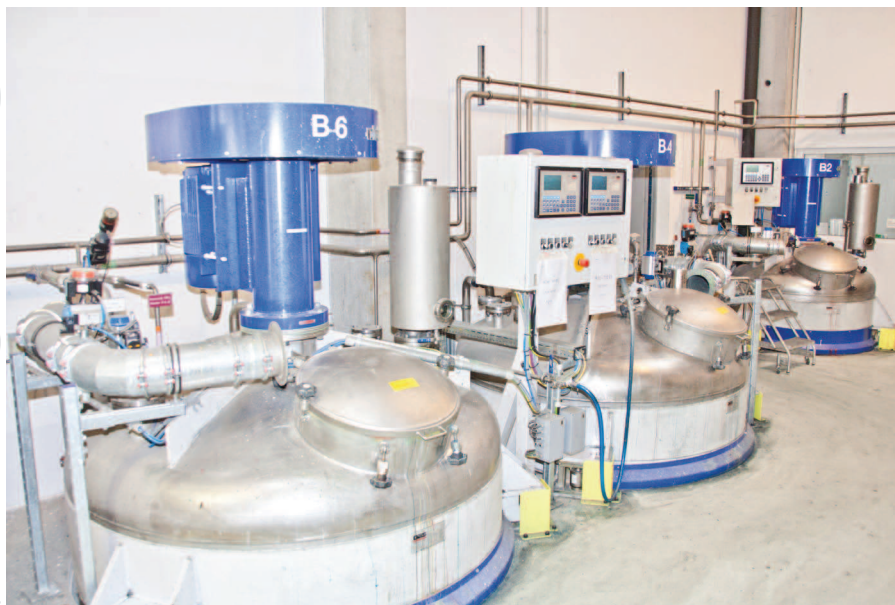
Geholit+Wiemer stellt seine Pigmentpasten mit hoher Präzision selber her. Dazu betreibt das Unternehmen eine aufwändige Lackfertigung mit zahlreichen Perlmühlen für die Pigmente und modernen Dosiersystemen für die Herstellung der Bindemittel und Lackbasen.
