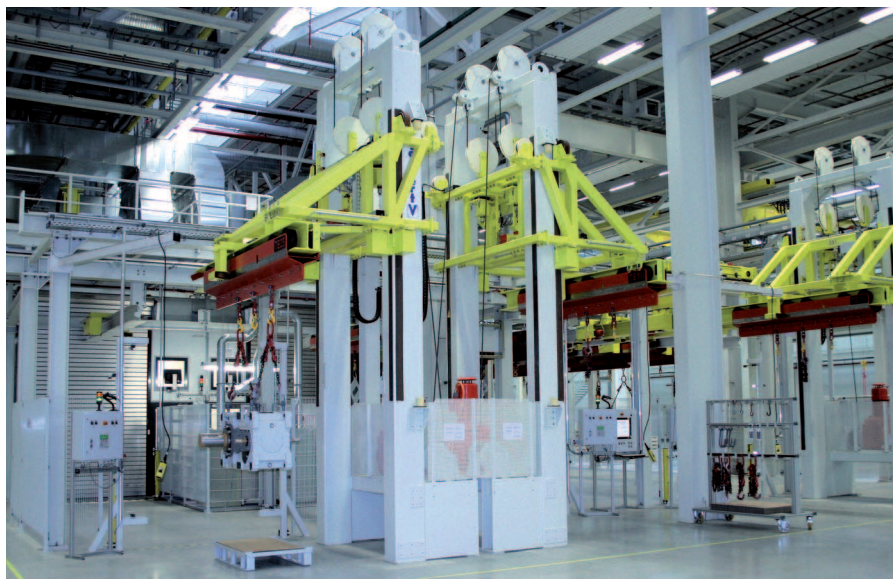
Per Reibradantrieb bietet die Lackierlinie maximale Flexibilität auf engstem Raum. Im Vordergrund sind die Manipulatoren zum Einschleusen und Ausschleusen der Getriebe zu sehen.
