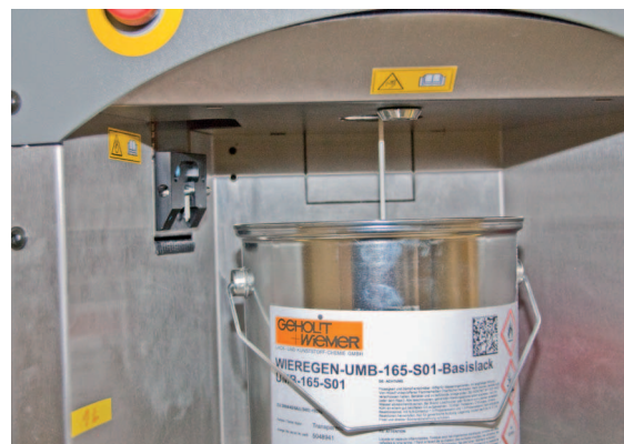
Es dauert nur wenige Minuten, bis ein Gebinde mit 4,5 kg fertig dosiert ist.
