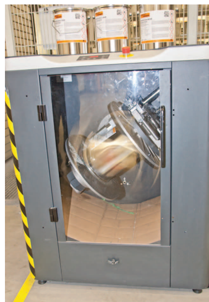
Sehr gut zum Mischen von Pigmentpasten und Lackbasis sind sogenannte Biaxial-Mischer. Aber auch Vibrationsmischer sind geeignet.
