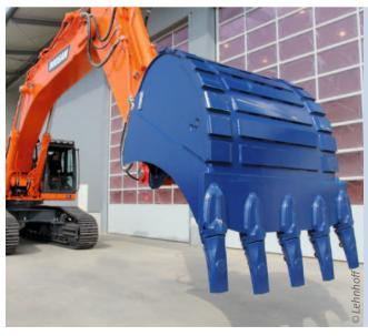
Bagger mit einem Löffel der Firma Lehnhoff. Die Lackierung erreicht die Korrosivitätskategorie C3-Schutzdauer Mittel gemäß DIN EN ISO 12944-2.
