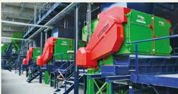
Zerkleinerungsmaschinen von Vecoplan. Die Maschinen werden im komplett montierten Zustand grundiert und decklackiert.
