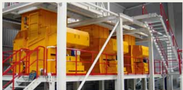
Zerkleinerungsmaschinen von Vecoplan. Die Maschinen werden im komplett montierten Zustand grundiert und decklackiert.
