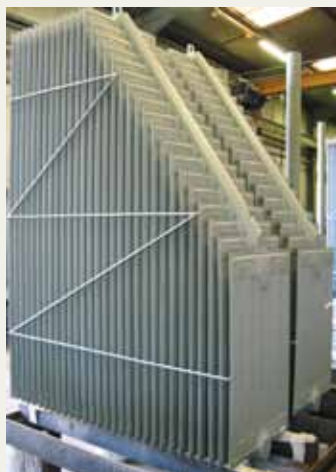
Kühlerelement vor der Auslieferung (links) und integriert in einen Transformator (rechts)
