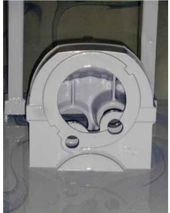
Flachgetriebegehäuse aus Gussstahl beim Herausfahren aus dem Lackbad
