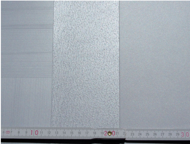
Bild 2. Deckbeschichtung in weißaluminium RAL 9006 (links gestrichen, Mitte gerollt und rechts gespritzt)
