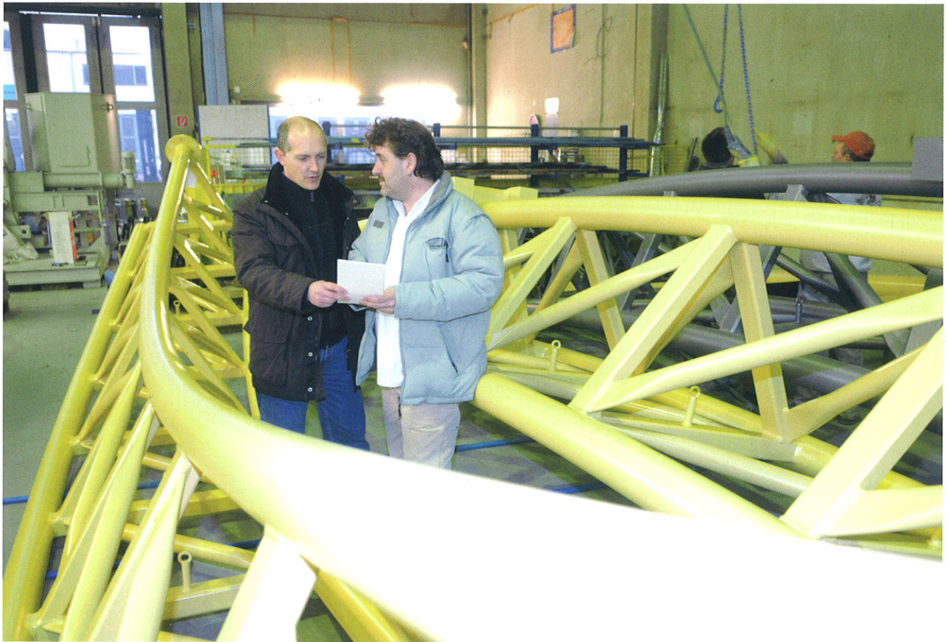
Strenge Kontrolle: Michael Schübler (links) und Winfried Schultis überprüfen anhand der Farben, ob die Beschichtung in der richtigen Reihenfolge aufgetragen wurde. Mit Hilfe eines Kammmessgeräts wird die Stärke des Lacks kontrolliert.
