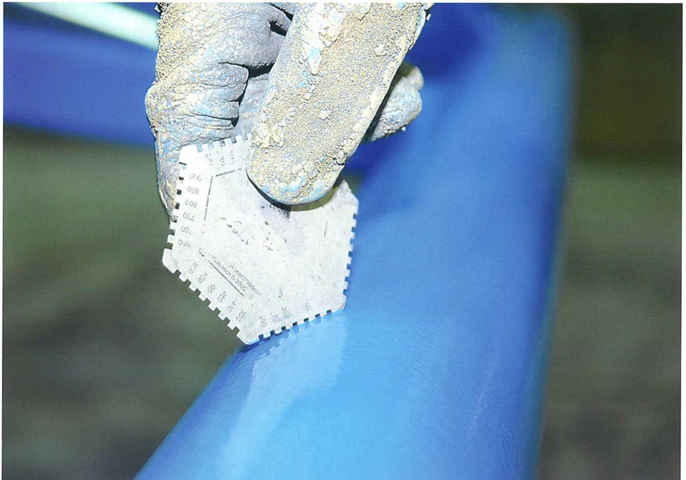
Strenge Kontrolle: Michael Schübler (links) und Winfried Schultis überprüfen anhand der Farben, ob die Beschichtung in der richtigen Reihenfolge aufgetragen wurde. Mit Hilfe eines Kammmessgeräts wird die Stärke des Lacks kontrolliert.
